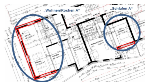
Ermittlung der Wärmebrücke 61: Ecke Außenwand III
