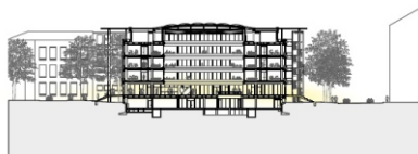
Gebäudequerschnitt mit neuem Staffelgeschoss und Folienkissendachkonstruktion
